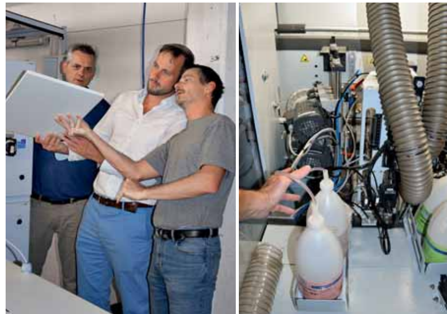
Links: Begutachtung der behandelten Musterteile. Rechts: die Applikationsstation für das Auftragen des „Aqua-Stop-Coating“ in der Kantenanleimmaschine
